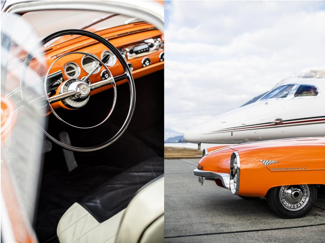
Das 2+2-sitzige „Cockpit“ war im Stil der karierten Flagge in Schwarz und Weiß gehalten (Sitze und Türverkleidungen). Der ebenfalls orange lackierte Instrumententräger wurde im „wrap-around“-Stil bis in die Türbrüstungen weitergeführt) und eine markante, abgestufte Mittelkonsole trennte die Schalensitze.
