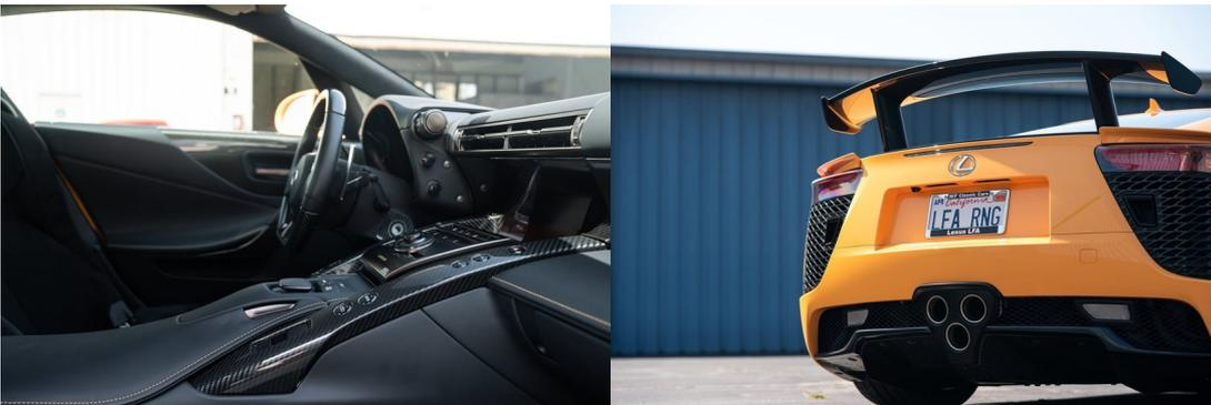
Außerdem widmeten sie sich die Optimierung der Aerodynamik und entwickelten einen neuen, fest verbauten Heckspoiler, einen vom Motorsport adaptierten Frontsplitter sowie einen Satz Luftleitbleche, die das Handling so verbesserten, dass das Auto eine Toppespeed von gut 323 Stundenkilometer und einen Sprint von 0 auf 100 Stundenkilometer in 3,7 Sekunden erreichen konnte.
