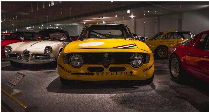
Dieser spezielle GTA ist ein Gruppe 5 Semi-Werks-Monzeglio Exemplar mit aggressiveren Kotflügeln, die ebenso wie die Hauben und Türen aus GFK gefertigt wurden. Zwischen 1968 und 1972 wurden 447 Einheiten des 1300 GTA hergestellt; 300 wurden zu Corsa Varianten und dominierten die Tourenwagenklassen jener Zeit.
