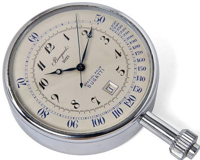
In den 1930er Jahren hatte Breguet von Ettore Bugatti den Auftrag erhalten, für das Armaturenbrett des luxuriösen Bugatti Royale sieben exklusive Chronographen mit 67 Millimetern Durchmesser zu fertigen. Die Uhr mit der Nummer 2023 stammt aus dieser Serie und trägt auf dem Zifferblatt eine Tachometerskala und eine Minutenanzeige, die in einem kleinen Fenster auf sechs Uhr erscheint. Breguet hat das geschichtsträchtige Stück unlängst bei Artcurial in Paris für 76.200 Euro ersteigert.
