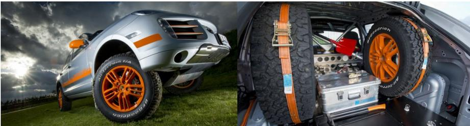
Bei der Transsyberia 2008 belegten [speziell vorbereitete Porsche Cayenne](#) die ersten sechs Plätze. Modifikationen umfassten eine verstärkte Ölwanne, Rallye-Stoßdämpfer, einen Überrollkäfig, eine verkürzte Achsübersetzung, einen auf dem Dach montierten Schnorchel und ein Navigationssystem zum Erkunden unbefestigter Wege. Für Exkursionen in die einsamsten Winkel der Erde werden Sie kaum einen verlässlicheren Partner finden. Der coolste Cayenne weltweit?
