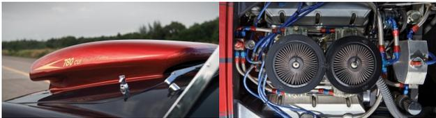
Doch gegen die 12,9 Liter Hubraum des V8-Nascar-Triebwerks war kein Kraut gewachsen. Der V8 leistete mindestens 1.100 PS – bei einem Leergewicht von 1.000 Kilogramm. Unübertroffenen ist bis heute wohl das Drehmoment von fast 1.800 Nm, das die Cobra bei optimaler Asphalttemperatur auf die Straße brachte. Die Viergang-Schaltung war sogar für 2.000 Nm ausgelegt.
