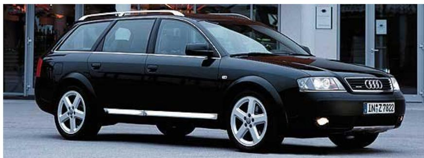
**Die neue Spitze heißt Audi allroad quattro 4.2, leistet 220 kW/300 PS und beeindruckt durch seine sportlichen Fahrleistungswerte. Dieser Motor steigert die Ausnahmestellung des Fahrzeugkonzepts mit 4-Level-Luftfederung, quattro-Antrieb und tiptronic mit dynamischem Schaltprogramm DSP und Sportprogramm weiter.**
