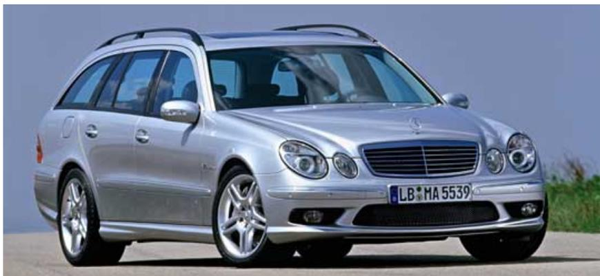
**Die Ausnahmestellung des neuen AMG-Hochleistungskombis wird sowohl beim Blick unter die Motorhaube, wie auch beim Öffnen der Heckklappe deutlich. Dank Kompressoraufladung schöpft der AMG-Achtzylindermotor aus 5,5 Liter Hubraum eine Leistung von 476 PS bei 6100/min und entwickelt zwischen 2650 und 4500/min ein Drehmoment von 700 Newtonmetern.**
