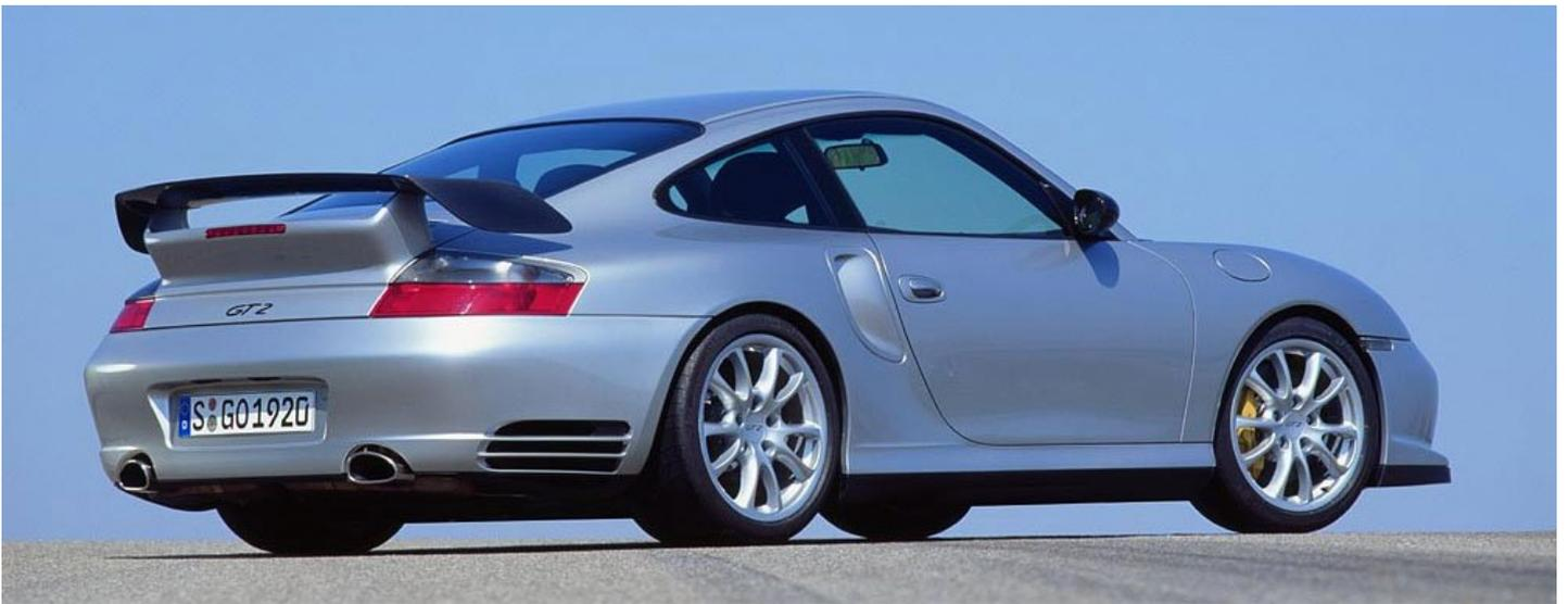
Äußerlich erkennbar ist die GT2-Generation des Jahrgangs 2004 an den neuen Rädern im GT3-Styling, die vorne 8,5 Zoll und hinten 12 Zoll breit sind. An der Vorderachse werden 235/40 R 18 Reifen aufgezogen, hinten sind es 315/30 R 18-Pneus.
