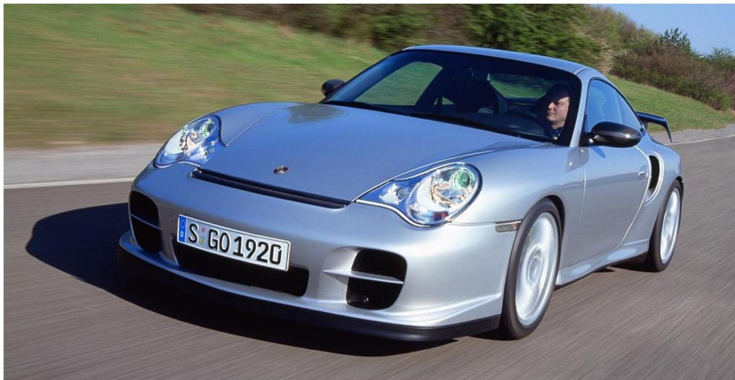
Extreme Sportlichkeit stand bei der Weiterentwicklung dieses leistungsstarken Turbo-Sportwagens klar im Vordergrund. Deshalb galt es nicht nur die Motorleistung zu erhöhen, sondern auch das Fahrwerk an Vorder- und Hinterachse weiter zu optimieren. Modifiziert wurde das Feder/Dämpfersystem sowie die Bremsanlage. Die Verzögerung erfolgt nun über ein Vierkanal-ABS, das noch feinfühler regelt.
