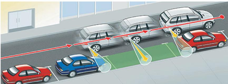
Auf der Fahrzeugseite entwickeln die BMW Ingenieure parallel dazu einen semi-automatischen Parkassistenten. Ein Sensor misst während der Vorbeifahrt an einem Parkplatz dessen Breite, Anfang und Ende. Ist die Parklücke groß genug, muss der Fahrer nur noch den Rückwärtsgang einlegen und den Parkassistenten aktivieren, der über einen Elektromotor die gesamte Lenkarbeit übernimmt.
