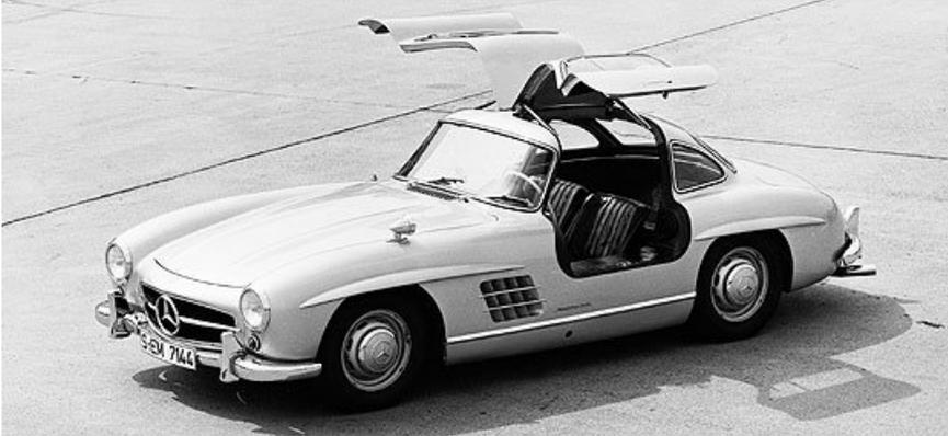
Die Karosserie des 300 SL wird zum größten Teil aus hochwertigem Stahlblech hergestellt, die Motorhaube, die Kofferraumklappe, die Schweller- und Türhaut jedoch aus Aluminium. Auf Wunsch und gegen einen verhältnismäßig geringen Aufpreis besteht die gesamte Karosserie aus Leichtmetall, was das Auto um 80 Kilogramm leichter macht. Doch diese Option gönnen sich nur 29 SL-Kunden – heute sind diese Autos sehr begehrt.
