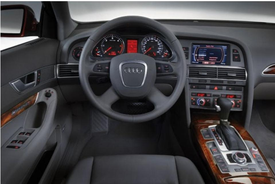
Im Innenraum dominiert die hohe und breite Mittelkonsole, die alle wichtigen Bedienelemente beinhaltet. Insgesamt bestimmt klare Sportlichkeit und ergonomische Perfektion das Interieur. Insgesamt ist der A6 größer geworden. Die Schulterfreiheit vorn fällt um 23 Millimeter größer aus, auch hinten gibt es sechs Millimeter mehr. Front- und quattro-Modelle verfügen über ein Kofferraumvolumen von 546 Litern.
