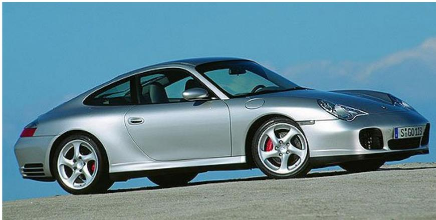
Die gelochten und innenbelüfteten Keramikverbund-Bremsscheiben mit einem Durchmesser von 350 Millimeter wiegen rund 50 Prozent weniger als Bremsscheiben aus Metall und verringern die ungefederten Massen beim 911 Carrera S um 14 Kilogramm. In Verbindung mit einem ebenfalls völlig eigenständigen Bremsbelag entwickeln die Keramik-Bremsscheiben sofort hohe und vor allem konstante Reibwerte während der Verzögerung.
