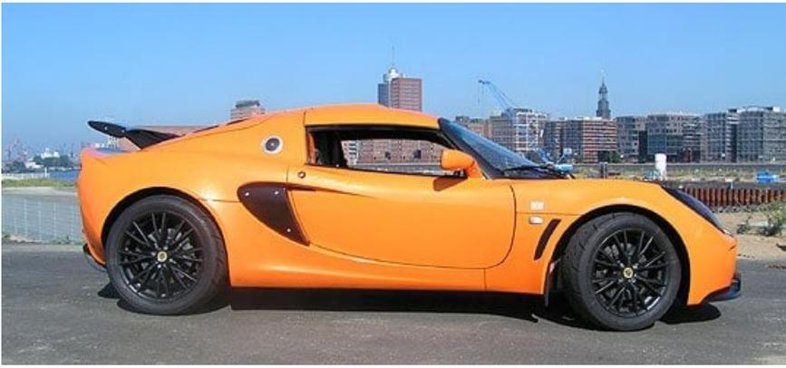
Ein bis zwei Fahrstufen leicht durchbeschleunigt, spürt man bereits das geringe Leistungsgewicht von nur 4,55 Kilogramm pro Pferdestärke. Der Tachozeiger des Exige verdeckt nach nur 5,2 Sekunden die 100-Marke auf dem Ziffernblatt und das trotz des niedrigen Drehmoments von 181 Nm. Erst bei rund 240 km/h erreicht der Zweisitzer seine Höchstgeschwindigkeit – ein bewegendes Gefühl und nur für harte Kerle geeignet.
