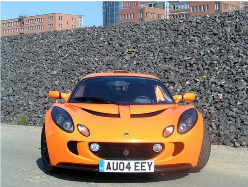
Schreck Nummer zwei folgt, wenn das 875-kg-Leichtgewicht seine 192 PS zum Überholvorgang mobilisiert. Wer schnell reagiert, kann sein athletisches Profil beim Vorbeiziehen zumindest erahnen. Diese Optik erlangt der Exige durch hohe Seitenwände und extrem flache Scheiben, großdimensionierte Lufteinlässe, seidenmatte 16-Zoll (vorn) und 17-Zoll (hinten) Leichtmetallfelgen im markanten Vielspeichen-Design sowie letztendlich dem dominanten Spoiler auf der Heckmotorhaube.
