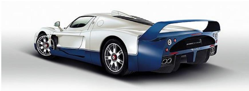
Der Maserati MC12 wird von einem 6 Liter V12-Mittel-/Heckmotor angetrieben, der eine maximale Leistung von 630 PS bei 7.500/min sowie ein maximales Drehmoment von 652 Nm bei 5.500/min entwickelt. Die Kraftübertragung erfolgt über eine Cambiocorsa-Sechsgangschaltung und ermöglicht eine Beschleunigung von 0-100 in nur 3,8 Sekunden. Seine Höchstgeschwindigkeit erreicht der MC12 erst bei rund 330 km/h.
