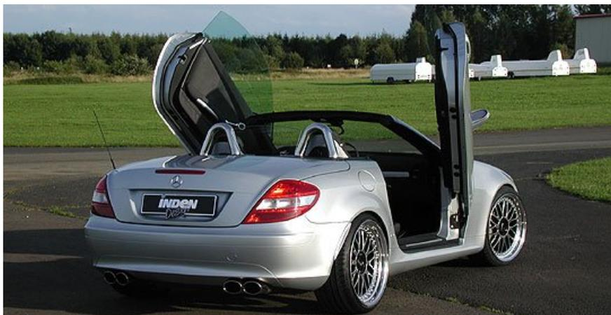
Der schon vom SLK 200 bekannte Edelstahl-Endschalldämpfer mit vier ovalen Endrohren kommt beim 350 ebenfalls zum Einsatz, lediglich der Querschnitt wurde ein wenig abgeändert.
