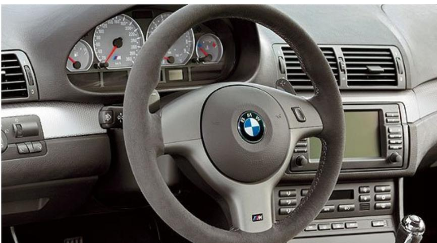
Sowohl das Lenkrad, als auch der Griff des Handbremshebels und – beim optional erhältlichen Sequenziellen M Getriebe – die Schaltknäuf-Applikationen sind aus Alcantara gefertigt. Aufgrund der M Track Mode-Taste in der rechten Speiche des Lenkrades entfallen die Multifunktions-Tasten.
