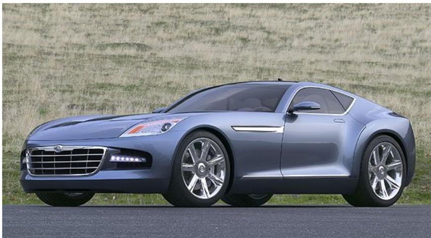
**Einen wahren Raketenstart legt das Chrysler Concept Car Firepower vor, wenn sein V8-Triebwerk zu grollen beginnt. Die Plattform des extravaganten Zweisitzers stammt - ebenso wie das Fahrwerk - aus der Dodge Viper SRT10. Anders als die Viper sitzt im Innern des Firepower ein 6,1 Liter HEMI-V8-Triebwerk, der maximale 425 PS zur Verfügung stellt.**
