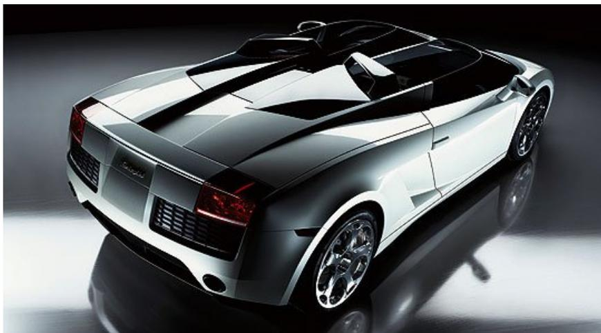
Zur Optimierung der Aerodynamik wurden spezielle Front- und Heckspoiler sowie ein mächtiger Heckdiffusor montiert. Ein im Windkanal versenkter Rückspiegel ermöglicht dem Fahrer via Tastendruck einen Blick auf den hinteren Teil des Sportwagens.
