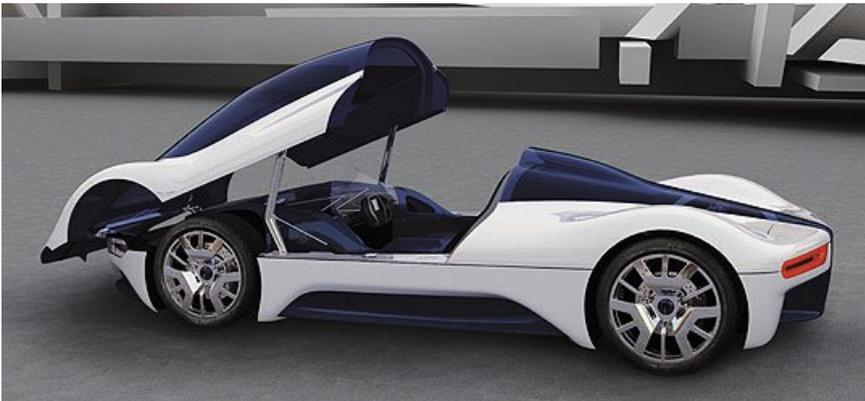
Die Fahrgastzelle ist in einen oberen durchsichtigen und in einen unteren Bereich unterteilt. Der großflächige obere Bereich gestattet den Insassen eine großzügige Rundumsicht, während der untere die Aufgabe einer die Aerodynamik unterstützenden „Schürze“ hat und gleichzeitig die gesamte Maserati Mechanik wie Pushrod Aufhängungen und die Ansaughutzen des Motors zur Schau stellt.
