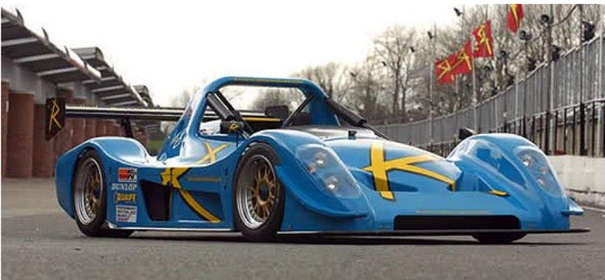
Wer nun denkt, schneller geht es nicht mehr, kennt den SR8 noch nicht. Diese Version wird mit einem aus der Formel 1 abgeleiteten Achtzylindermotor von Powertec ausgestattet, der als 2,0-, 2,6- und 3,0 Liter-Variante mit bis zu 500 PS verfügbar sein wird. Der erste Prototyp dieser Baureihe, Powertec RPA 2.6-litre V8, leistete ganze 363 PS bei 10.300 Touren sowie ein maximales Drehmoment von 240 Nm bei gleicher
