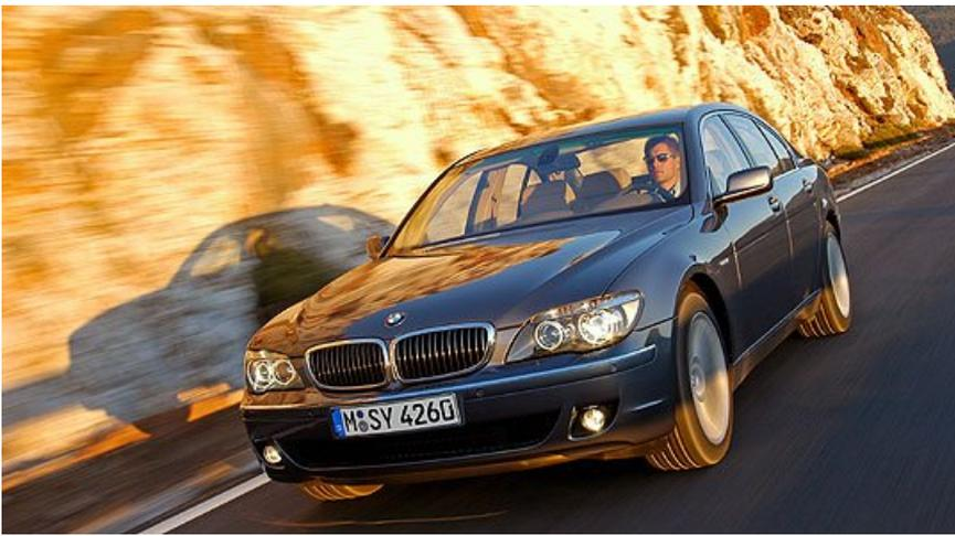
Ich selbst fahre einen 750i mit dem 4,8 Liter-Achtzylinder-Motor. Die 367 PS beschleunigen die Limousine ohne Probleme, so dass mir der mit 5,9 Sekunden angegebene Spurt von Null auf hundert Stundenkilometer durchaus realistisch erscheint. Spurtreu und souverän meistert das „Schiff“ die Serpentina der andalusischen Berglandschaften. Die ausgeklügelte Fahrwerksabstimmung lässt einen so dahinschweben, in der Ferne vernehme ich Indiomusik – der Kondor lässt grüßen!
