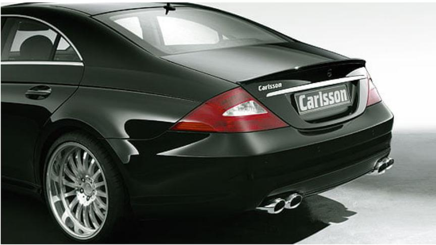
Per Chip erfolgt die Tieferlegung der serienmäßigen Luftfederung um circa 30 mm. Neben einer sportlicheren Optik bewirkt sie eine Reduzierung der Seitenneigung und damit eine verbesserte Fahrdynamik. Wesentlicher Bestandteil der neuen „C-Tronic Suspension“ ist ihre intelligente Elektronik, die bei schlechter Wegstrecke selbstständig eine Anpassung der Federwege vornimmt und so Unebenheiten automatisch ausgleicht.
