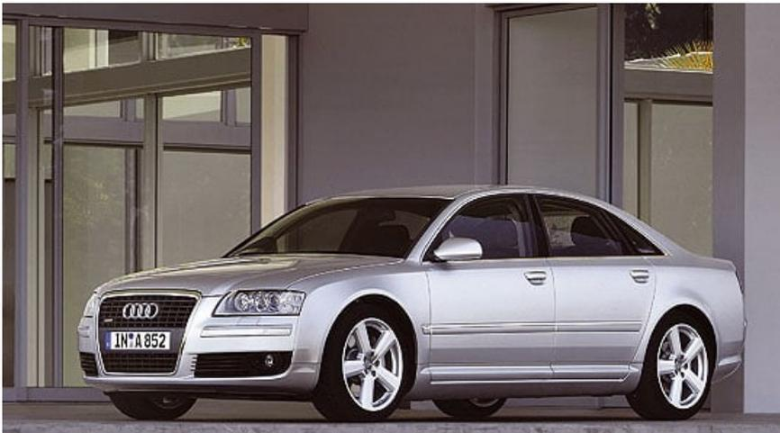
**326 PS:** Mit dieser Leistung setzt sich der neue Audi A8 4.2 TDI quattro an die Spitze aller Diesel-Pkw weltweit. Der neue 4,2 Liter große Achtzylinder mit Biturbo-Aufladung beschleunigt die Luxuslimousine mit einem maximalen Drehmoment von 650 Nm in nur 5,9 Sekunden von 0 auf 100 km/h. Die Höchstgeschwindigkeit wird elektronisch auf 250 km/h begrenzt. Zusätzlich zu diesen dynamischen Qualitäten besteht das neue Aggregat durch ruhige Laufkultur.
