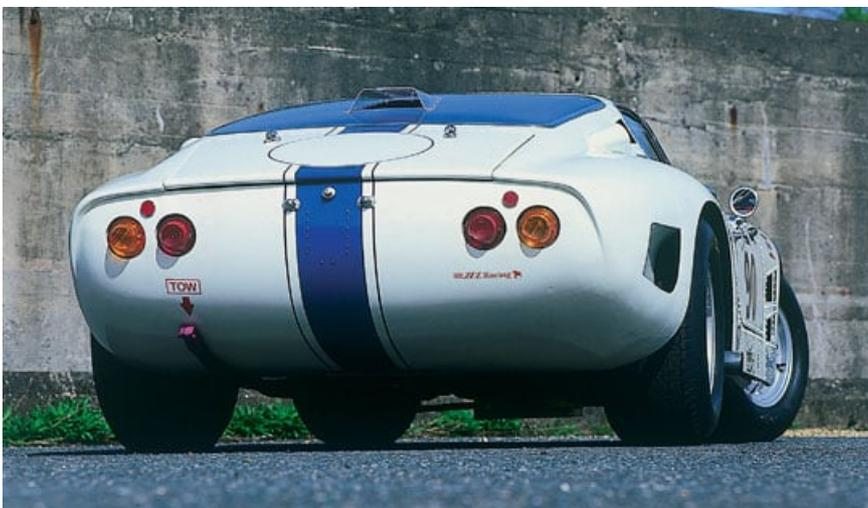
Ausgestattet mit einem Chevrolet V8-Motor leistet die „Corsa“-Version 405 PS und die „Strada“-Variante 363 PS. Letztere schafft den Sprint von 0 auf 100 km/h in rund sechs Sekunden. Mit einer Höchstgeschwindigkeit von 257 km/h war der Iso Grifo A3/C der Ferrari-Schreck seiner Zeit. Der hier abgebildete Wagen hat allerdings durch einige kleine Modifikationen etwas mehr Leistung - er verfügt über rund 500 PS.
