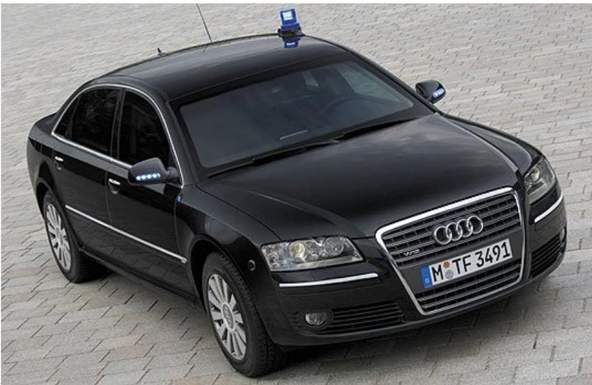
Angetrieben wird der neue A8 Security vom 450 PS starken Zwölfzylinder, der die Langversion trotz ihres erhöhten Gewichts zügig vorantreibt. Übersetzt wird die Kraft von einer sechsstufigen Automatik und dem Quattro-Allradantrieb. Speziell für das Mehrgewicht wurden die Bremsanlage und Luftfederung neu angestimmt.
