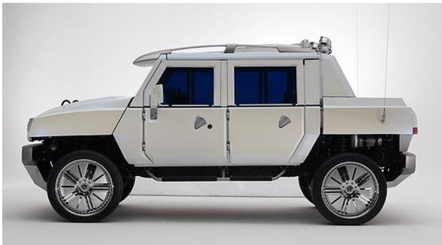
Fiat setzt dagegen auf einen sparsamen Dieselantrieb, der den 4.870 mm langen, 2.200 mm breiten und 2.050 mm hohen Offroader mit 185 PS bei 3700/min. und einem maximalen Drehmoment von 456 Nm bei 1800/min. vorantreibt. Die Kraftübertragung erfolgt über ein Sechsgang-Automatikgetriebe permanent an alle vier Räder. Hierbei handelt es sich um 26-Zoll-Aluräder mit Pirelli-Spezialreifen der Größe 315/40 R26!
