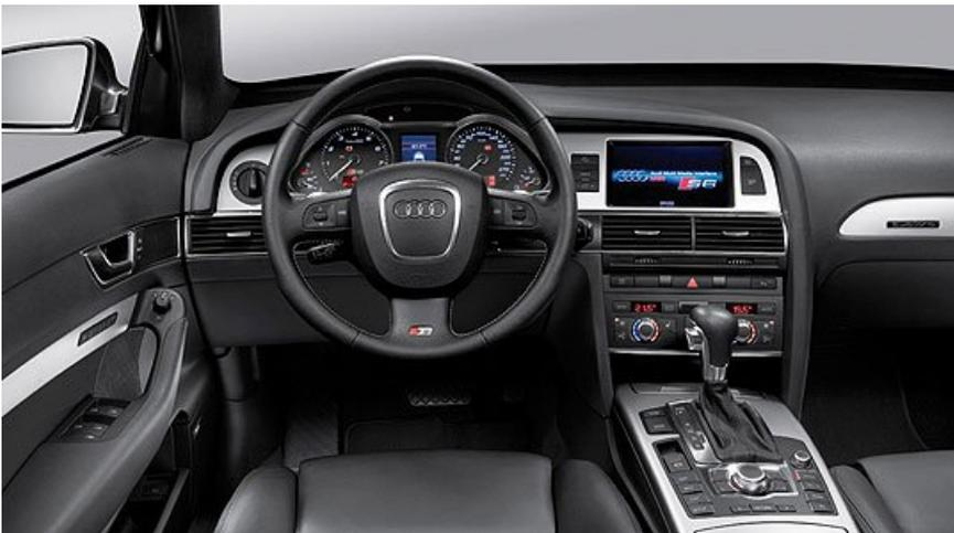
Im Innenraum des Audi S6 finden sich unter anderem neue Sportsitze mit integrierten Kopfstützen, hochwertige Leder-/Alcantara-Bezüge und die Komfortklimaautomatik plus mit getrennter Temperaturverteilung für Fahrer und Beifahrer.
