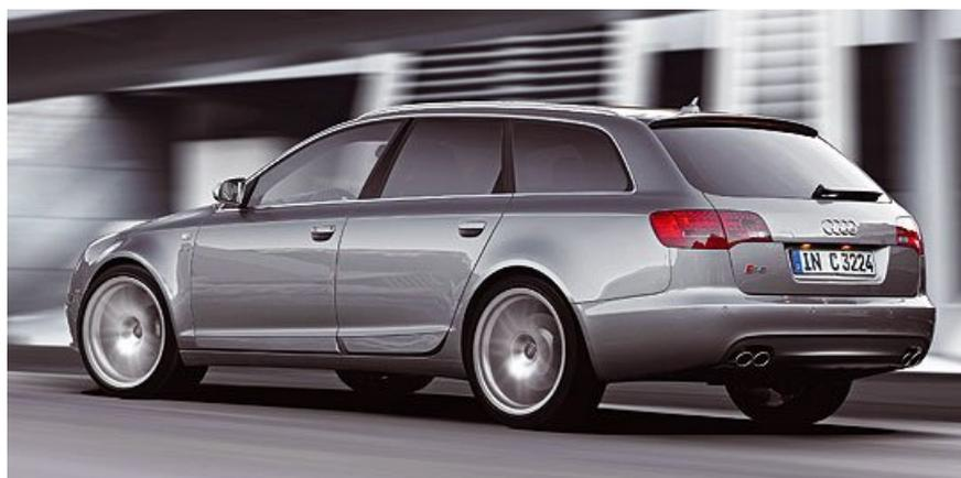
Der 5,2-Liter-Motor des neuen Audi S6 basiert - wie schon das S8-Aggregat - auf dem Zehnzylinder des Lamborghini Gallardo. Um den Abstand zum S8 zu wahren, wurde die S6-Variante jedoch auf 420 PS bei 6.800/min gedrosselt. Unverändert blieb dagegen das Drehmoment von 540 Newtonmetern zwischen 3.000 und 4.000/min. Den Sprint von Null auf 100 km/h erledigt die S6 Limousine in 5,2 Sekunden; der Avant benötigt 5,3 Sekunden. Bei 250 km/h begrenzt die Elektronik automatisch den Vorwärtsdrang.
