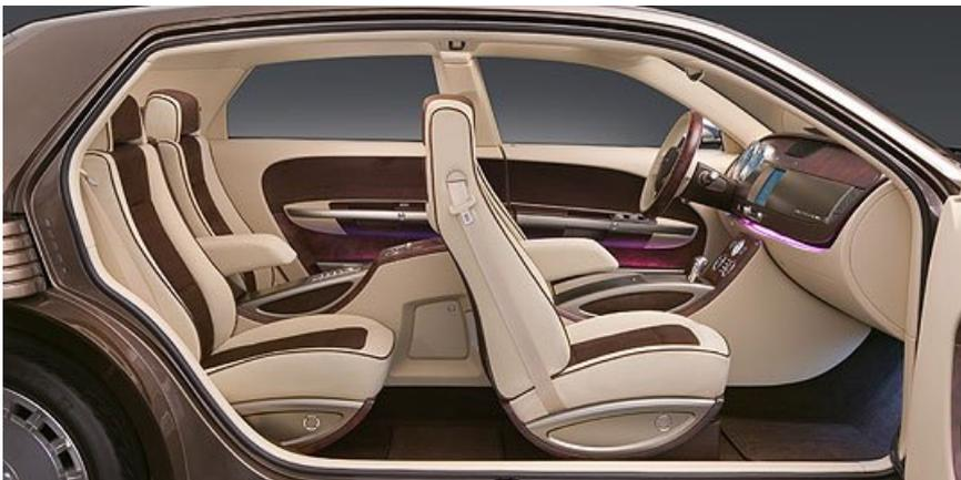
Der Zugang ins Innere des Flaggschiffs erfolgt dank fehlender B-Säule und gegenläufig öffnenden Türen höchst komfortabel. Die Interieur-Ausstattung umfasst eine Kombination aus beigem und braunem Leder, dunklen Wurzelholz-Armaturen sowie bronzefarbenen Applikationen – die fließenden Übergänge der Holz- und Bronzeelemente in der Instrumententafel sollen an die Tradition der frühen Imperials anknüpfen.
