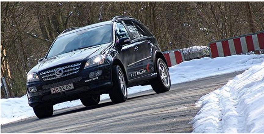
Neuester Geländerenner: der Kleemann ML50K S8, der unter Leistungsgesichtspunkten das obere Ende der Fahnenstange markiert. Das Kürzel 50K steht hier für den Hubraum des Achtzylinders und den eigens von Kleemann entwickelten Kompressor, der im wesentlichen für den Leistungszuwachs verantwortlich ist.
