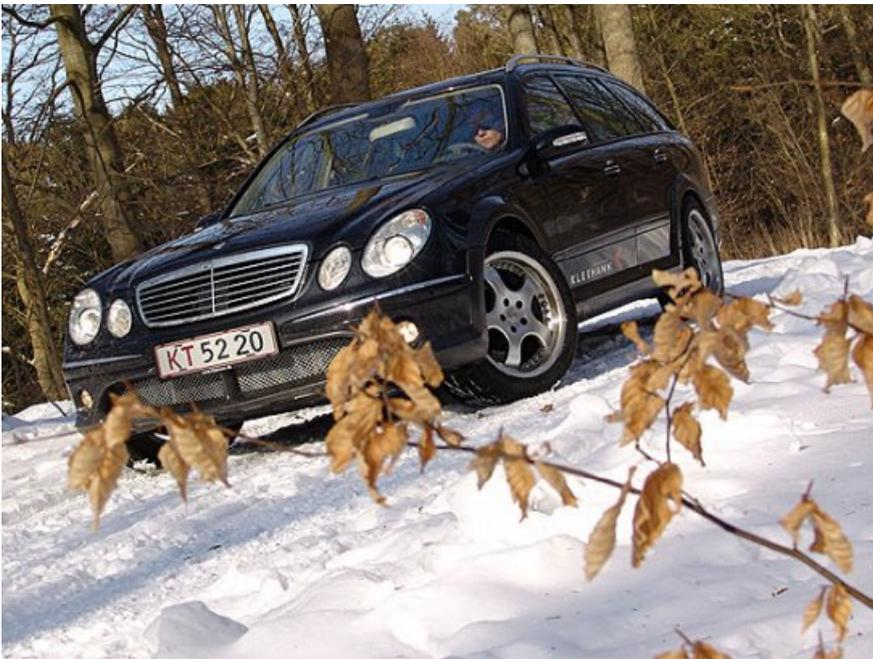
Eine höhere Bodenfreiheit erreicht der Kleemann E50KCC erst durch seine Rad-Reifen Kombination aus 18 Zoll Felgen und Reifen der Dimension 255/45-ZR18 sowie Radaufhängungen aus der S-Klasse. Optimierung von Rampenwinkeln sind kein Thema, weil der Wagen mit seinem Frontspoiler-Design und der Heckschürze auch noch ein auskömmliches Arrangement mit der Aerodynamik finden muß.
