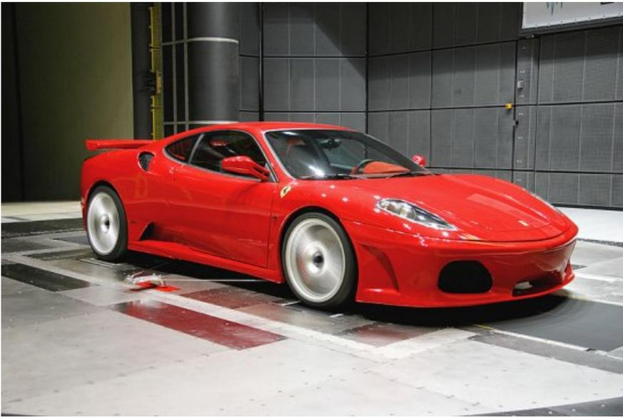
Das gesamte Paket inklusive Frontschürze, Heckdiffusor, Schweller und Heckflügel optimiert den Abtrieb um 8,1 kg auf der Vorderachse und 35,3 kg an der Hinterachse. So bietet der F430 von Novitec dem Fahrer bei hohen Geschwindigkeiten mehr Sicherheit und Fahrvergnügen.
