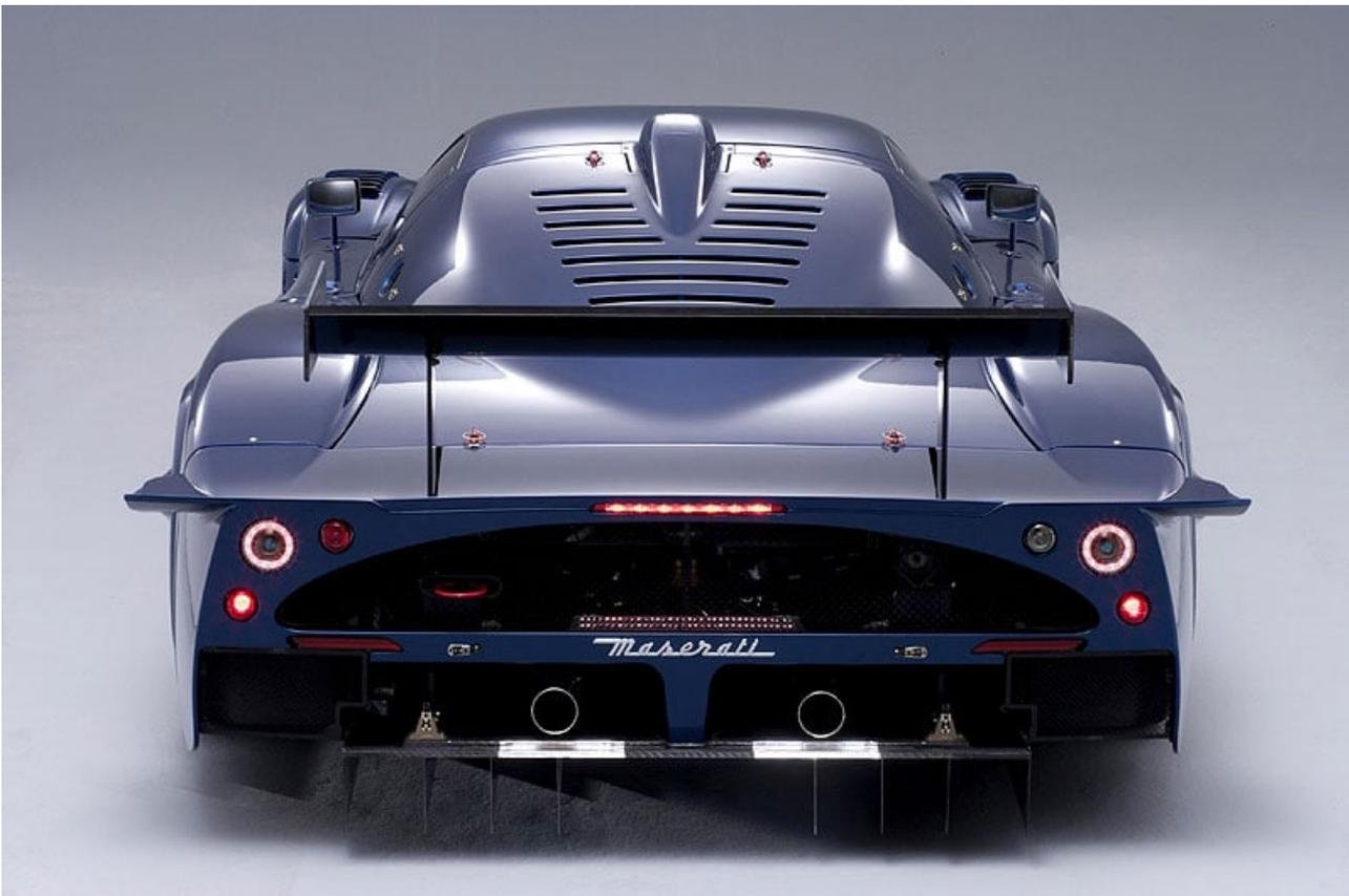
So offeriert der MC12 Versione Corse auch ähnliche Fahrleistungen: Angetrieben von einem 755 PS (bei 8.000/min.) starken V12-Triebwerk, das ein maximales Drehmoment von 710 Newtonmetern bei 6.000/min. entwickelt, beschleunigt der Mittelmotorsportwagen in brachialen 6,4 Sekunden von 0 auf 200 km/h. Ja, Sie haben richtig gelesen: 0 - 200! Die Höchstgeschwindigkeit ist bei 326 km/h erreicht.
