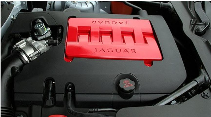
Bei der zweiten Leistungsstufe schalten die Ingenieure zusätzlich einen Kompressor zwischen den Ansaugtrakt. Der aufgeladene Achtzylinder leistet beachtliche 480 PS und 640 Nm bei 3850/min. Mit dem kraftvollen Antrieb verkürzt sich die Beschleunigungszeit auf 4,8 Sekunden von Null auf 100 km/h. Zum Vergleich: die 298 PS starke Serienversion XK benötigt für den Sprint 6,2 Sekunden. Die schnellste Raubkatze aus dem Jaguar-Gehege, der XKR, schafft den Spurt in 5,2 Sekunden.
