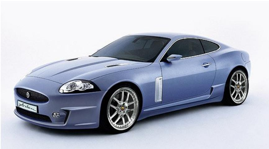
**Jaguar-Spezialist Arden hat die Krallen des XK Coupé scharf gefeilt. Durch Hubraumerweiterung und eigens entwickelter Kompressoraufladung leistet das Triebwerk des AJ 20 Coupés bis zu 480 PS. Hinzu kommen ein aerodynamischer Sportanzug und ein individuell wählbarer Feinschliff des Interieurs.**
