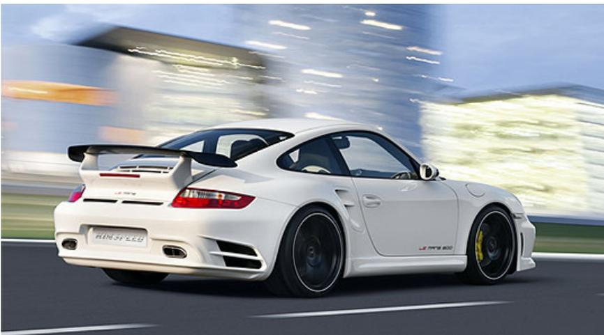
Den Kontakt zur Straße stellen die Rinspeed typischen 20 Zoll Alu Räder im Design C5/1 her. Speziell für den Turbo wurde die Hinterachsfelge auf 12 x 20" erweitert. Bereift mit 245/30 R20 an der Vorderachse und 325/25 R20 an Hinterachse, gibt es ausreichend Grip für den schnellen Schweizer.
