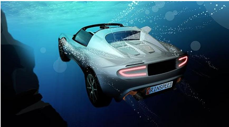
An Land soll ein drehmomentstarker Elektromotor die Hinterräder antreiben. Auf dem Wasser sollen zwei Heckschrauben für kräftigen Vortrieb sorgen und für ein zügiges Vorankommen unterhalb der Wasseroberfläche sind zwei leistungsstarke Jetantriebe im Bug des sQuba vorgesehen. Die Leichtbaukarosserie aus futuristischen Carbon-Nano-Tubes-Teilen umgibt strömungsgünstig den Fahrer und den Beifahrer, die sich unter Wasser aus dem bordeigenen System mit Atemluft versorgen.
