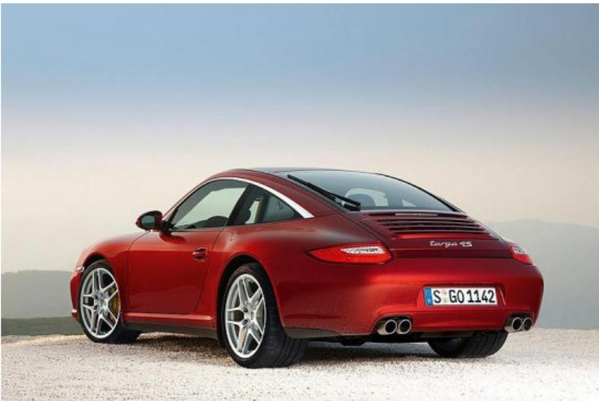
Das 1,54 m<sup>2</sup> große Glasdach mit integriertem Schiebedach verfügt jetzt über ein neues blickdichteres Rollo, das geschlossen die komplette Schiebedachfläche abdeckt und unabhängig vom Dach elektrisch bewegt werden kann.
