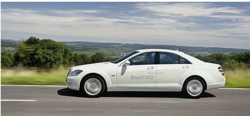
Bei dem kompakten Hybridmodul handelt es sich um einen scheibenförmigen Elektromotor, der auch als Anlasser und Lichtmaschine dient. Das System bietet doppelten Nutzen: Zum einen hilft es, Kraftstoff zu sparen, zum anderen erhöht es den Fahrspaß. Ein Grund dafür ist der so genannte Boost-Effekt, durch den der Elektromotor den Verbrennungsmotor in der verbrauchsintensiven Beschleunigungsphase mit einem Drehmoment von maximal 160 Newtonmetern kraftvoll unterstützt.
