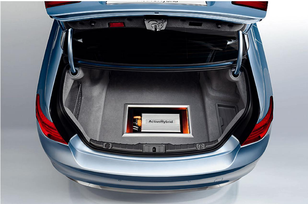
Das „Mild-Hybrid-Konzepts“ unterstützt den Verbrennungsmotor bei der Beschleunigung Darüber hinaus erzeugt das E-Aggregat durch Bremsenergie-Rückgewinnung Strom, der die Lithium-Ionen-Batterie im Kofferraum speist.
