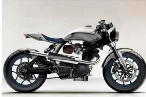
Auch in Fragen des Antriebs geht man bei Mac Motorcycles ganz eigene Wege. Den typischen V2-Motor sucht man in den technischen Spezifikationen vergebens. Angetrieben werden die Macs von einem ursprünglichen, bollernden, luftgekühlten, 492 Kubikzentimeter großen Buell-Einzylinder-Motor mit einer Leistung von 34 PS. Wem diese Leistung nicht ausreicht, kann ab Werk ein „Plus-Kit“ ordern, mit dem die Leistung auf 50 PS gesteigert wird.
