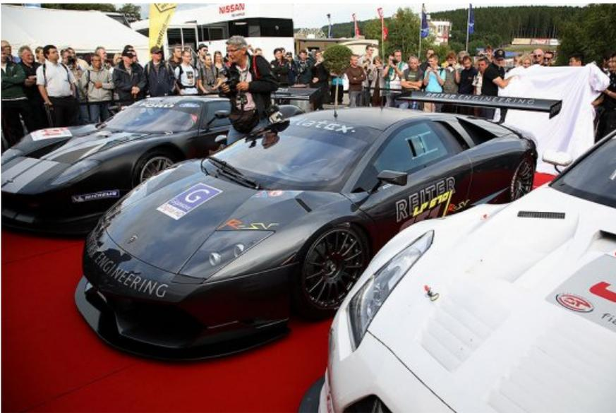
Unverkennbar ist seine veränderte Optik – extrem und kompromisslos. Eine komplette Außenhaut aus Karbon zielt die Lamborghini-FIA-Rennversion. Das Gesamtgewicht beläuft sich auf gerade einmal 1.150 kg (plus Zusatzgewicht, um dem FIA-2010-Reglement zu entsprechen). Die signifikant veränderte Karosserie bewirkt insgesamt eine verbesserte aerodynamische Effizienz im Vergleich zum Vorgänger-Modell, dem Murciélago R-GT.
