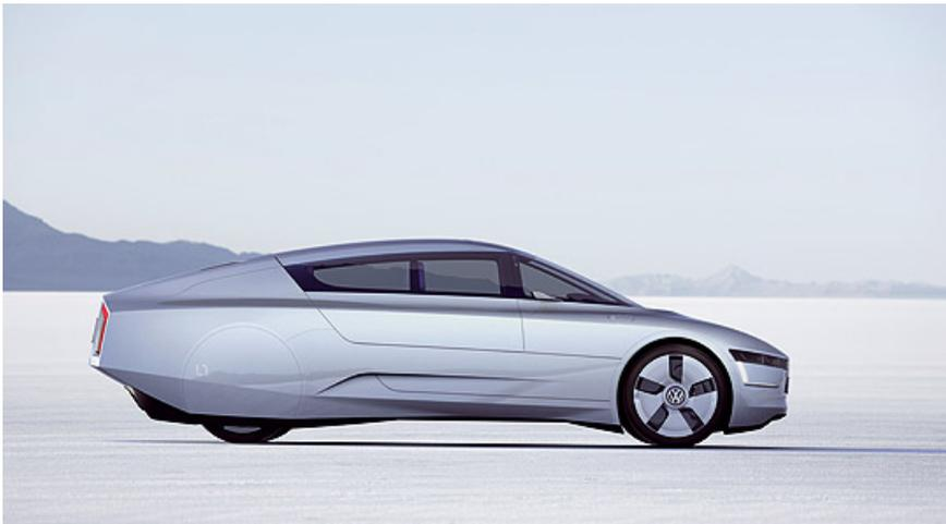
**Zum Thema Nachhaltigkeit zeigt Volkswagen in Frankfurt eine weiterentwickelte Generation des „1-Liter-Autos“, Projektname L1, und bricht im Auftrag der Sparsamkeit rigoros mit konventionellen Fahrzeugaufbauten. Der stromlinienförmige L1 mit hintereinander angeordneten Sitzen wird von einem Hybrid aus TDI- und E-Motor angetrieben und verbraucht im Schnitt knapp über einen Liter Kraftstoff auf 100 km.**
