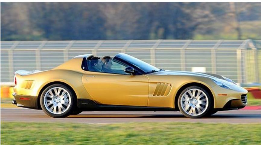
Vom Auftrag bis zu ersten Testfahrten auf der Ferrari-Hausstrecke Fiorano vergingen nur 14 Monate. Trotz der aufwendigen Targa-Konstruktion inklusive verstärkter Karosserie wiegt der Ferrari P540 Superfast Aperta nur 20 Kilogramm mehr als das 599 GTB Coupé, auf dessen Chassis das Einzelstück basiert. Unter anderem konnte dies durch den Einsatz von Karbon-Karosserieteilen erreicht werden.
