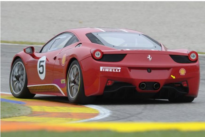
Für eine optimale Aerodynamik wurde die Karosserie zudem um 30 Millimeter abgesenkt. Mehr Kurvendynamik versprechen härtere Federn und Aluminium-Dämpfer sowie Pirelli-Rennbereifung auf 19-Zoll-Rädern mit Zentralverschluss. Dahinter sitzen leistungsstarke Brembo CCM2-Bremsen, die auch im Experimental-Supersportwagen 599XX zum Einsatz kommen.
