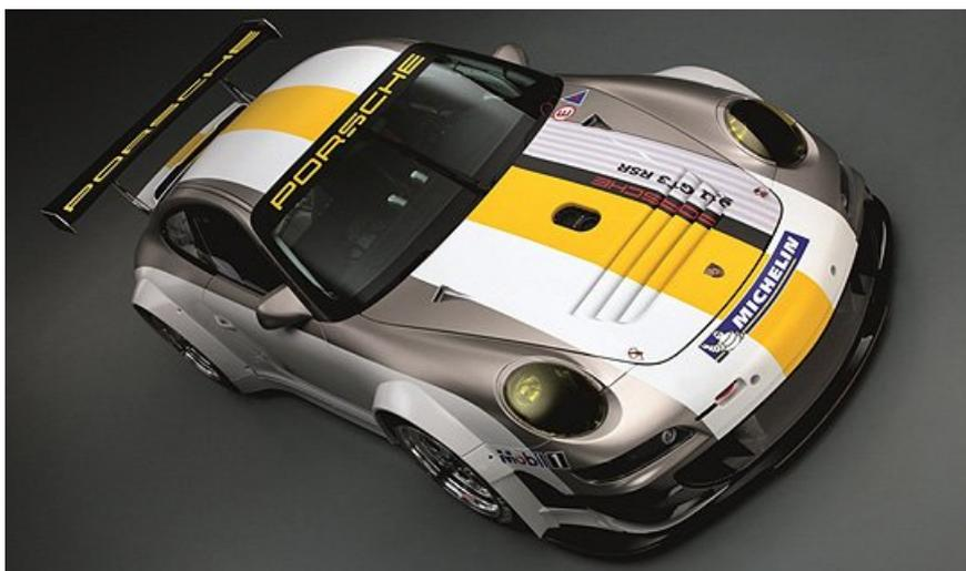
**Porsche hat seinen Rennwagen 911 GT3 RSR für die kommende Saison überarbeitet. Die Leistung des 4,0-Liter-Boxermotors steigt dank Änderungen an Motorsteuerung, Abgasanlage und Luftansauganlage um 5 PS auf 455 PS. Die Maximaldrehzahl liegt weiterhin bei 9.400 Touren.**
