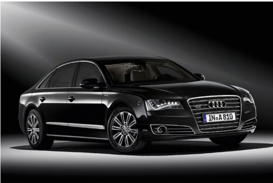
Angetrieben wird der Panzerwagen vom bewährten W12-Aggregat. Aus 6,3 Liter Hubraum schöpft das Triebwerk 368 kW/500 PS Leistung und 625 Nm Drehmoment. Damit beschleunigt er in 7,3 Sekunden von 0 auf 100 km/h. Mit Rücksicht auf die Reifen wurde die Höchstgeschwindigkeit allerdings bei 210 km/h abgeriegelt. Der Verbrauch liegt, laut Hersteller, bei respektablen 13,5 Liter auf 100 km.
