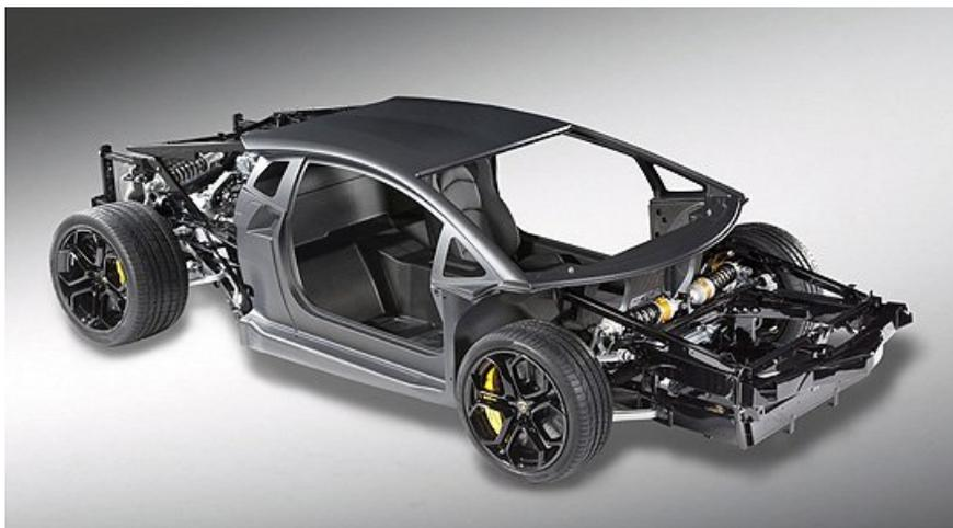
**Auch Lamborghini sieht Carbon als den Werkstoff der Supersport-Zukunft. Der Nachfolger des Zwölfzylinder-Boliden Murciélago, der in Genf Premiere feiert, nutzt diese Technik für eine Insassenzelle nach Vorbild der Formel-1-Rennwagen. Das Monocoque wird vollständig aus Kohlenstofffasern hergestellt und von Lamborghini in einer neuen Produktionsstätte am Stammsitz Sant'Agata Bolognese gefertigt.**
