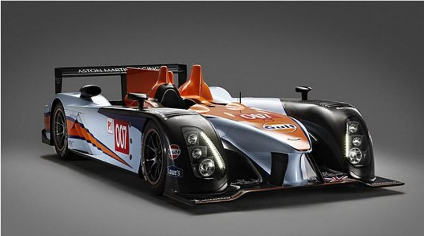
**Als Reaktion auf das neue Reglement für den Intercontinental Le Mans Cup hat Aston Martin einen komplett neuen LMP1-Rennwagen vorgestellt: Der AMR-One ersetzt den bekannten 6,0 Liter V12-Motor durch einen Reihensechszylinder-Benziner mit nur zwei Litern Hubraum und verzichtet zudem auf ein Dach.**
