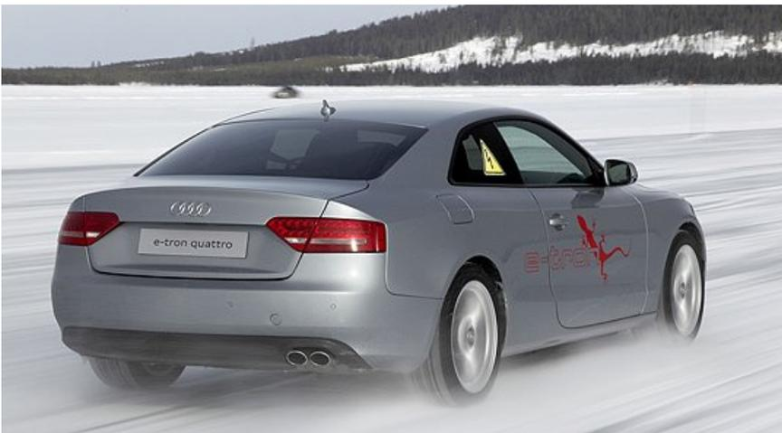
Während beim normalen Quattro das Mittendifferenzial für die Kraftverteilung zwischen Vorder- und Hinterachse sorgt, geschieht dies beim Plug-In-Hybrid rein elektronisch. Beeindruckend ist die schnelle Reaktionszeit des Systems, während der A5 durch Schnee und Eis pflügt: Die Elektromotoren reagieren extrem sensibel auf Antriebsschlupf, die Räder drehen selbst bei schnellen Kurven und Drifts kaum durch und sortieren sich in Windeseile für die optimale Kraftverteilung.
