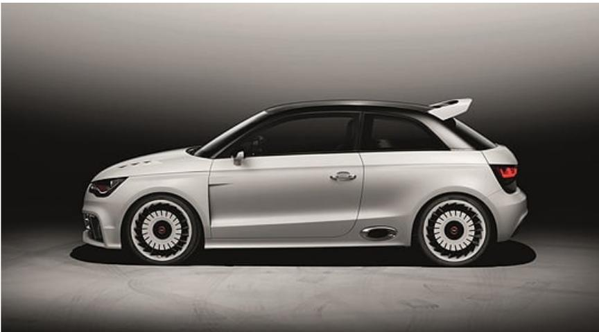
Dank des niedrigen Gewichts von nur 1.390 Kilogramm – neben einigen Carbon-Teilen auch Resultat des Verzichts auf eine Rückbank – erreicht der A1 Clubsport Fahrleistungen wie sonst nur Supersportwagen. Der Standardsprint auf 100 km/h dauert lediglich 3,7 Sekunden, Tempo 200 ist nach 10,9 Sekunden erreicht. Die Höchstgeschwindigkeit ist elektronisch auf 250 km/h begrenzt.
