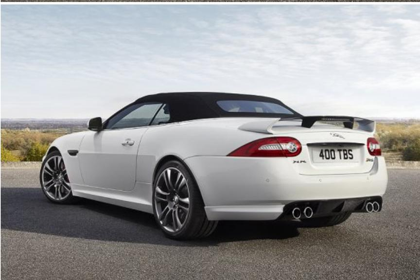
Die Karosserie wurde im Frontbereich und der Seitenpartie um neue Lufteinlässe zur Beatmung des Motors ergänzt, während am Heck ein neuer Spoiler aus Kohlefaser den nötigen Abtrieb bei hohen Geschwindigkeiten garantieren soll. Breitere und gleichzeitig leichtere Räder sorgten für den Kontakt zur Straße. Bis auf das
